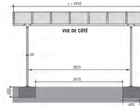
Les carports Ozone®, Singulier® et Pluriel® sont à cheviller dans des plots bétons de 400x400x400 ou dans une chape.
