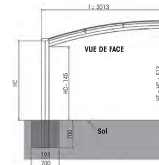
Les pieds OXYGEN® sont à sceller dans des plots béton.
