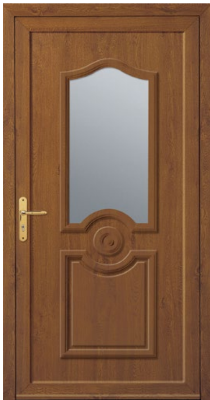
ARTÉMIS ○ (A) €€ Vitrage Satinovo (en option) H max: 2288 mm - H min: 1928 mm L max: 1166 mm - L min: 876 mm Coef. Ud: 1,1
